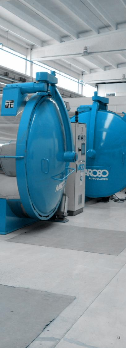
AUTOCLAVE A2 VOLUME LL 28.000 Pressure autoclave L 28.000
